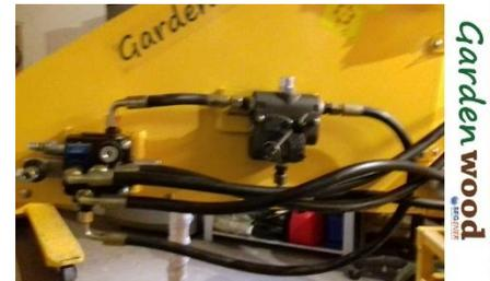
**AVANCE O RETROCESO DE LAS RAMAS EN LA TOLVA.** Permite establecer si el rodillo impulsa hacia los cuchillos la madera o la impulsa en reversa, hacia afuera.
