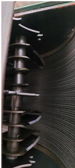
El molino de martillos funciona según el principio de que la mayoría de los materiales se triturarán o pulverizarán con el impacto mediante los siguientes pasos: En primer lugar, los materiales se introducen en la cámara del molino típicamente por gravedad.
