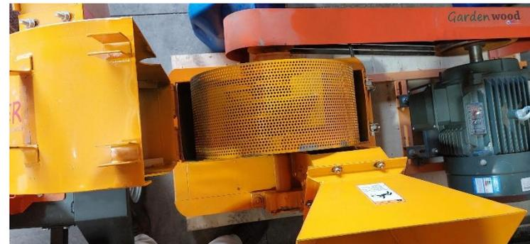
**Componentes de la Trituradora:** Compuesta de una cámara, rodeada de malla milimétrica, que contiene en su interior volante de 100 kilos donde van montados los cuchillos, mas un sistema de múltiples martillos, lo que asegura un óptimo triturado.
