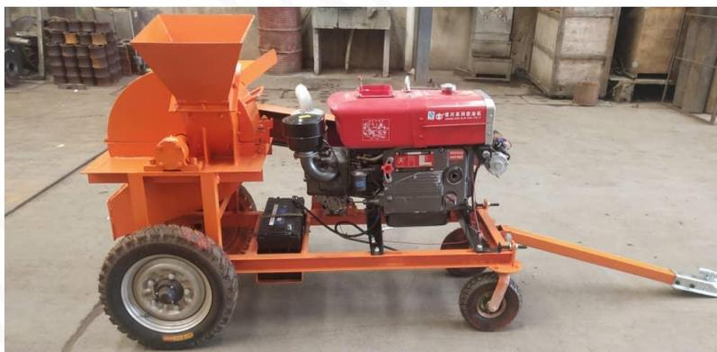
Esta chipeadora y trituradora esta provista de un **volante o disco, donde van montados los cuchillos, con un peso de más de 100 kilos, acompañado de un conjunto de martillos de más de 20 unidades.**
