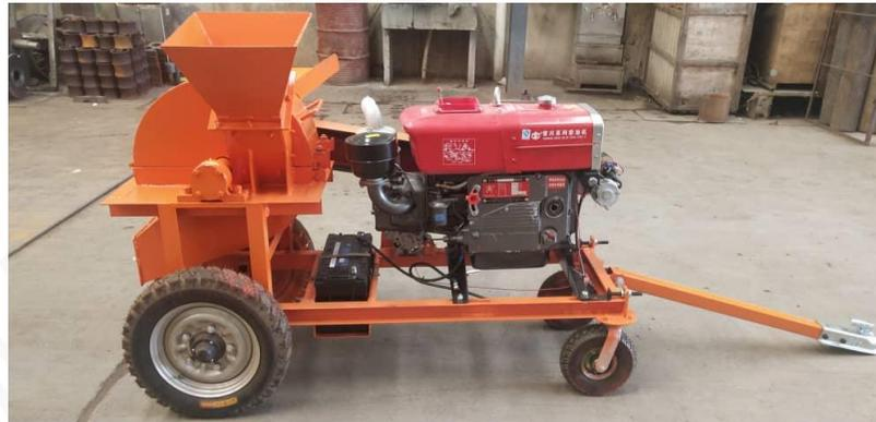
Esta chipeadora y trituradora esta provista de un **volante o disco, donde van montados los cuchillos, con un peso de más de 100 kilos, acompañado de un conjunto de martillos de más de 20 unidades.**
